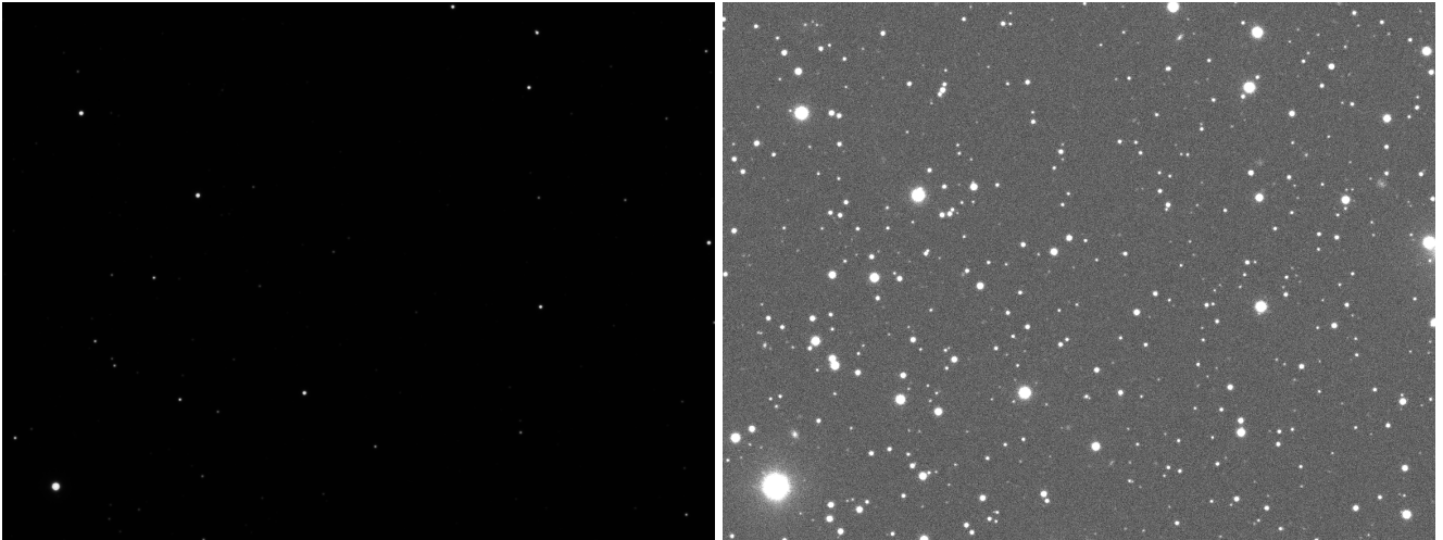
Abbildung 1: Eine einzelne Rohaufnahme für die Untersuchung der Lichtkurve des Exoplaneten QATAR-4b. Auf der linken Seite ist das eigentliche Rohbild gezeigt, das Grundlage für die quantitative Auswertung ist. Die rechte Seite zeigt das gleiche Bild nach einer extremen Histogrammtransformation, so dass alle Sterne sichtbar werden. Bei genauerem Hinsehen (Zoom) wird auch das Rauschen im Himmelshintergrund sichtbar.
